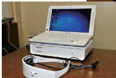
補助事業の助成を受け購入されたNIRS脳計測装置。この装置を使って音楽を聴きながら自転車を漕いだ時の脳データを調べる。
