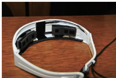
頭につけるヘッドセット。ここから額に近赤外光を照射し、前頭前野部分の血流量の変化を計測することで脳活動の様子が判る。
