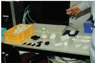
樹脂の粉を、レーザーで焼いて固めて製品を作ります。作られた製品。樹脂の粉の種類によって、強度を変える事が出来ます。
