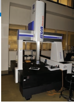
1000分の1mmまで寸法測定ができる三次元測定機。
