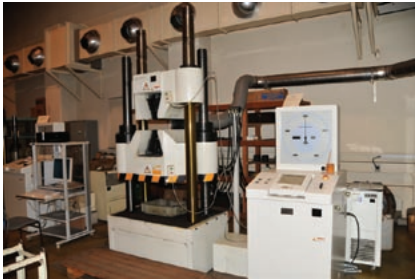
1000kN万能試験機。金属の強度試験を行う機器。
