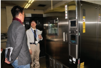
恒温恒湿低温槽。温度、湿度を管理し製品の耐久性等を調べる。
