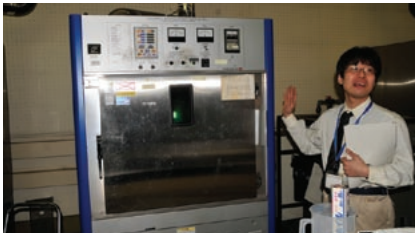
デューサイクルサンシャインウェザーメーター。色々な気象条件を作り出し、製品の色々な耐久性を検査できる。
