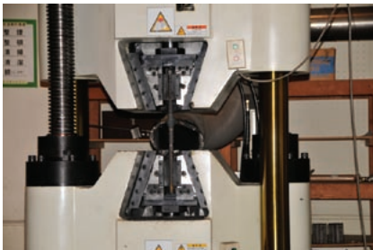
建設に使う鉄筋の圧接部の良否を見る破断検査。
