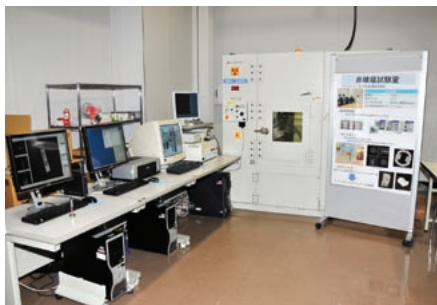
非破壊試験室に置かれたマイクロフォーカスX線透視検査装置とX線CTスキャン。
